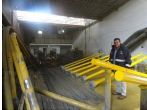
Foto 10. Se observa que no existe espacio libre para la circulación de los operarios. La bodega está completamente llena de postes para pintar, tubería para la fabricación de postes, tapas para cajas de paso, etc.
