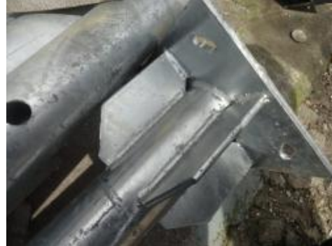
Foto No 12 Detalle de los deficientes acabados de los postes: escoria, cordones de soldadura sin pulir, orificios mal ubicados y deficientes acabados (rebabas)
