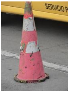
Foto No 15: Se observa el mal estado de los conos viales ya que se encuentran decolorados, sin base de sustentación para garantizar la estabilidad y las bandas reflectivas blancas prácticamente no se ven.
