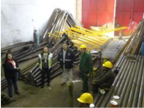
Foto 9. Panorámica de la bodega de Tevaseñal S.A. En este sitio se almacena tubería, tapas para las cajas de paso de la red semafórica, varillas. Adicionalmente se pintan y se ensamblan los mástiles de los postes soldándolos a los postes de mástil
