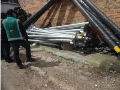
Foto No 11 Almacenamiento de los postes para semáforos en acero, con un tratamiento de galvanizado en caliente, los cuales no fueron recibidos por la Entidad ni la interventoría por la pésima calidad, es decir sin cumplir con las especificaciones técnicas.
